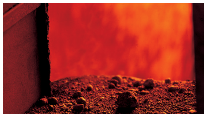
L'espansione e la cottura dell'argilla espansa raggiunge i 1200 °C.
