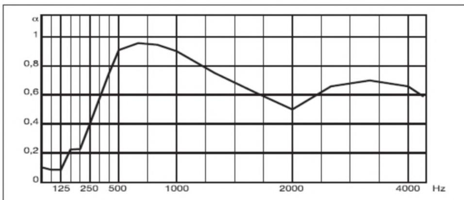
Il diagramma riporta l'andamento del coefficiente α in funzione della frequenza. La prova è stata eseguita secondo la ISO 354 presso l'Istituto Galileo Ferraris di Torino.
