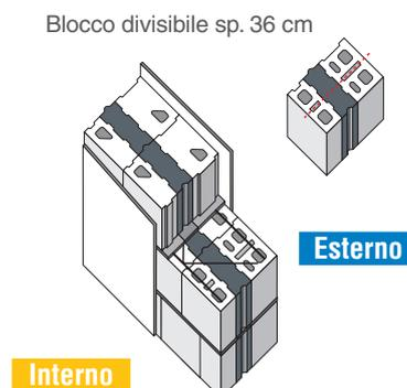
Formazione della spalla delle aperture con Blocco divisibile sp. 36 cm.
