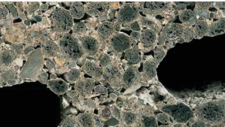
La porosità dell'impasto di calcestruzzo Leca ottimizza la traspirabilità delle pareti in Lecablocco Bioclima.
