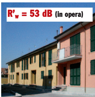
Palazzina a Massarosa (LU) Lecablocco Fonoisolante spessore 25 cm
